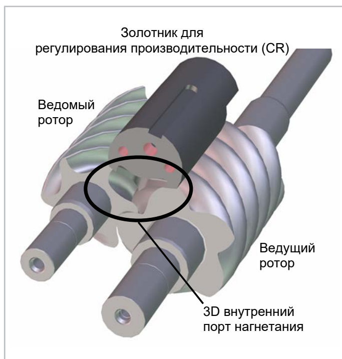
Рис. 5: Схематичный 3D вид CR золотника между ведущим и ведомым ротором
