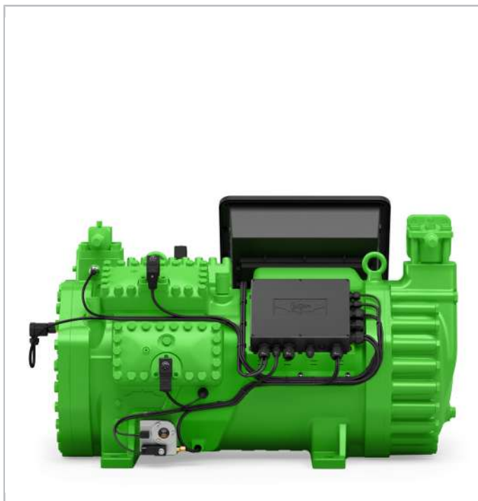
Рис. 12: Пример оснащения 8-ми цилиндрического компрессора с компрессорным модулем CM-RC-02, датчиком температуры нагнетаемого газа, датчиками давления, подогревателем масла, регулятором производительности CRII, реле давления масла и регулятором уровня масла OLM-IQ.
