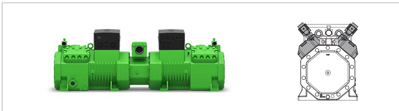
Fig. 4: Compresseur tandem ECOLINE à 4+4 cylindres. À gauche : vue latérale, à droite : vue du couvercle de palier, gris : régulation de puissance CRII
