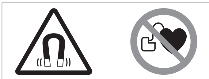
Fig. 16: Panneaux d'avertissement et d'interdiction sur un compresseur avec moteur à aimant permanent
