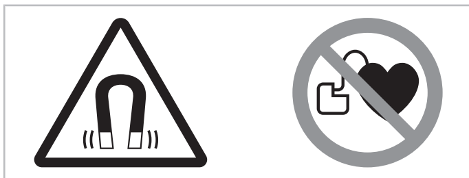
Fig. 11: Panneaux d'avertissement et d'interdiction sur un compresseur avec moteur à aimant permanent
