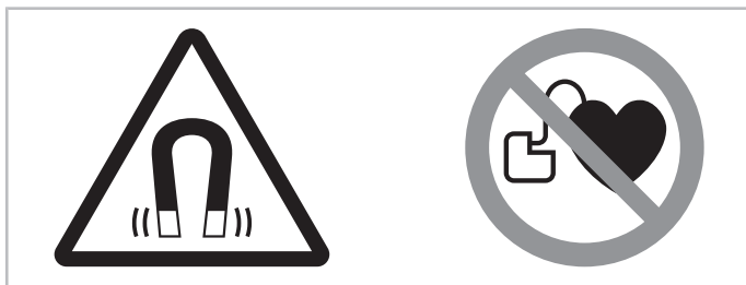
Abb. 16: Warn- und Verbotsschilder auf einem Verdichter mit Permanentmagnetmotor
