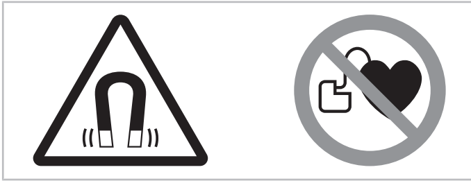
Abb. 11: Warn- und Verbotsschilder auf einem Verdichter mit Permanentmagnetmotor
