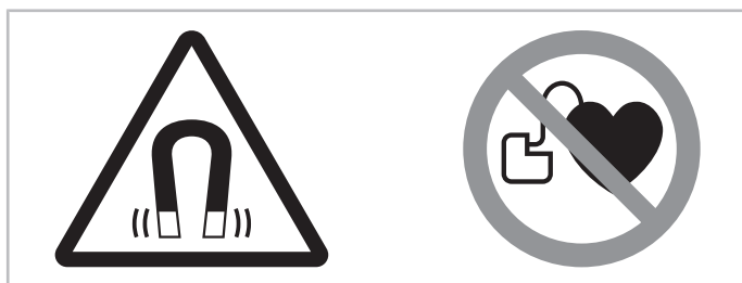
Рис. 11: Предупреждающие и запрещающие знаки на компрессоре с мотором с постоянными магнитами
