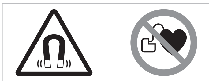
Рис. 16: Предупреждающие и запрещающие знаки на компрессоре с мотором с постоянными магнитами
