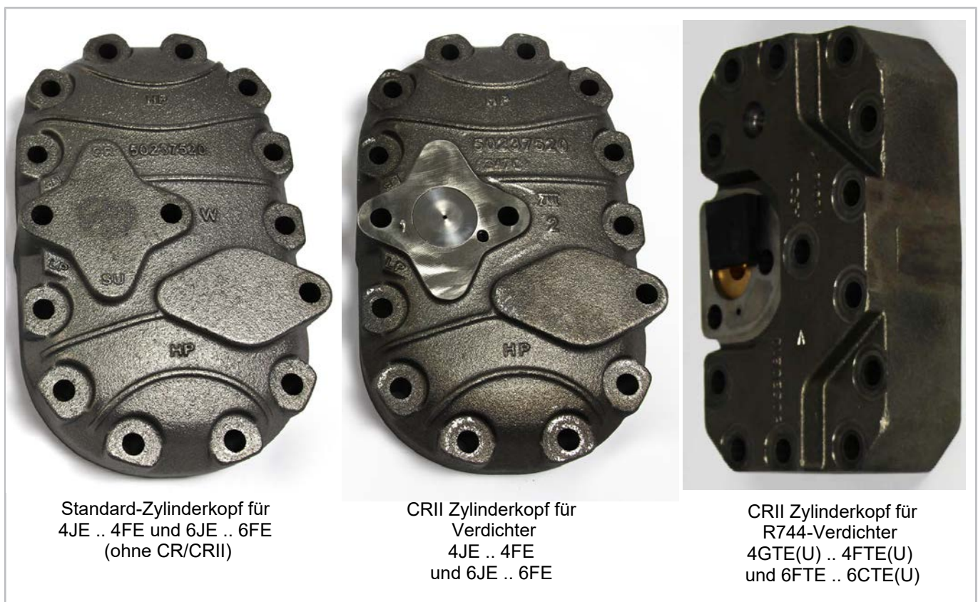
Abb. 1: Vergleich Standard-Zylinderkopf (links) zu Zylinderköpfen für Leistungsregelung mit zusätzlichen Bohrungen (mitte und rechts).
