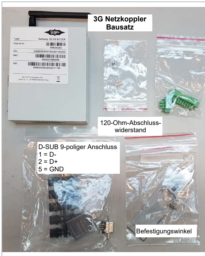
Abb. 2: Netzkoppler Bausatz (Teilenummer 347 992 01) für Montage im Schaltschrank
