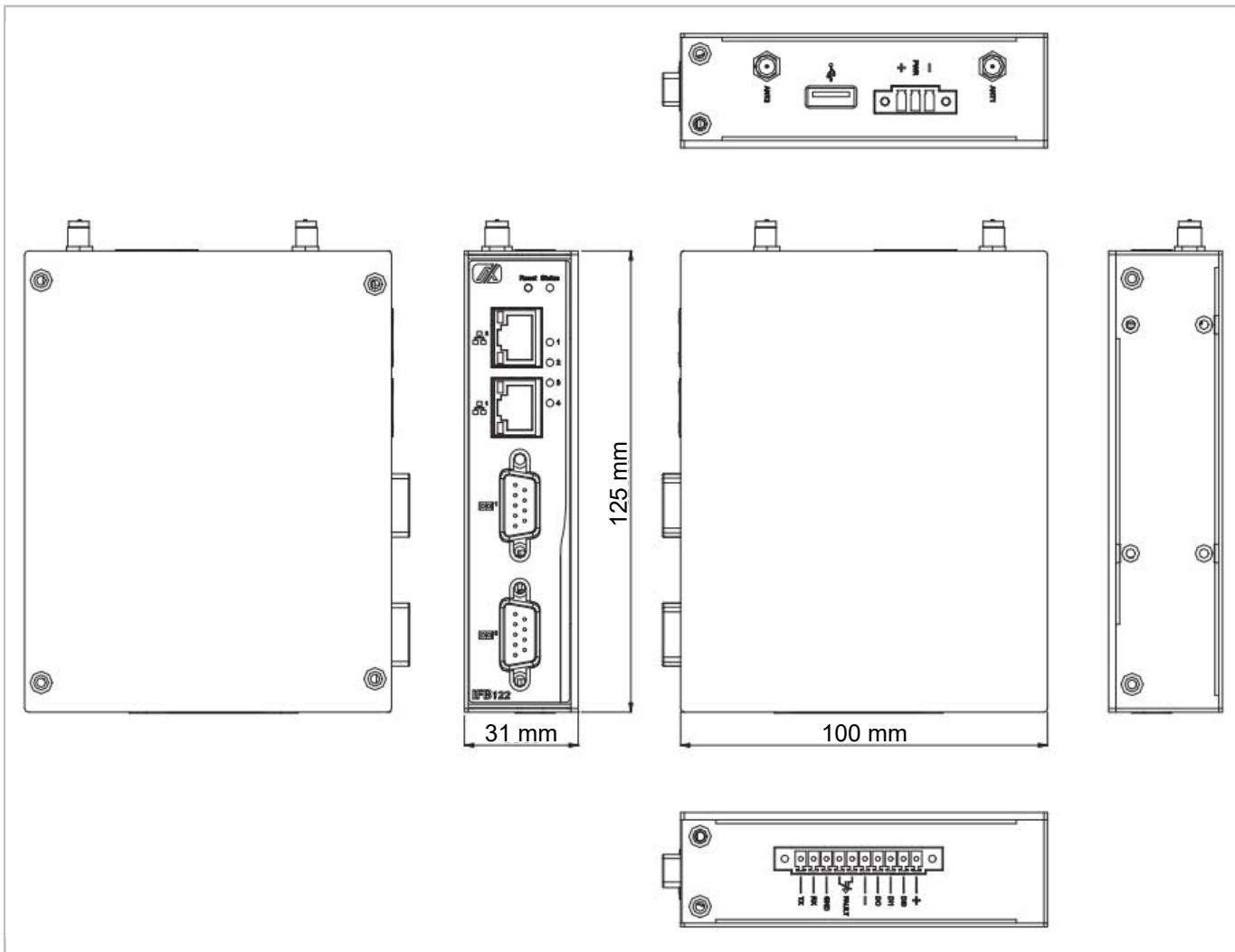
Fig. 4: Dimensions de la passerelle
