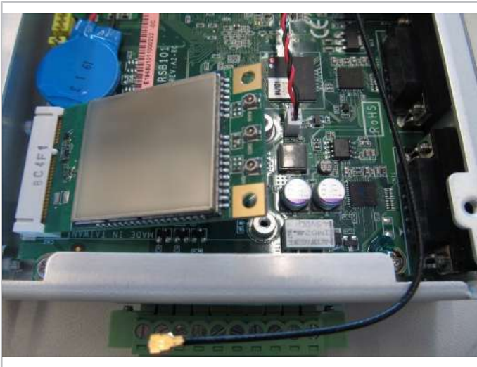
Fig. 20: Retirer le module GSM.
