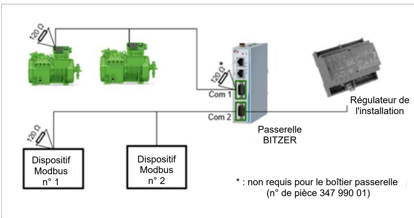
Fig. 25: Configuration en pont : paramétrage général
