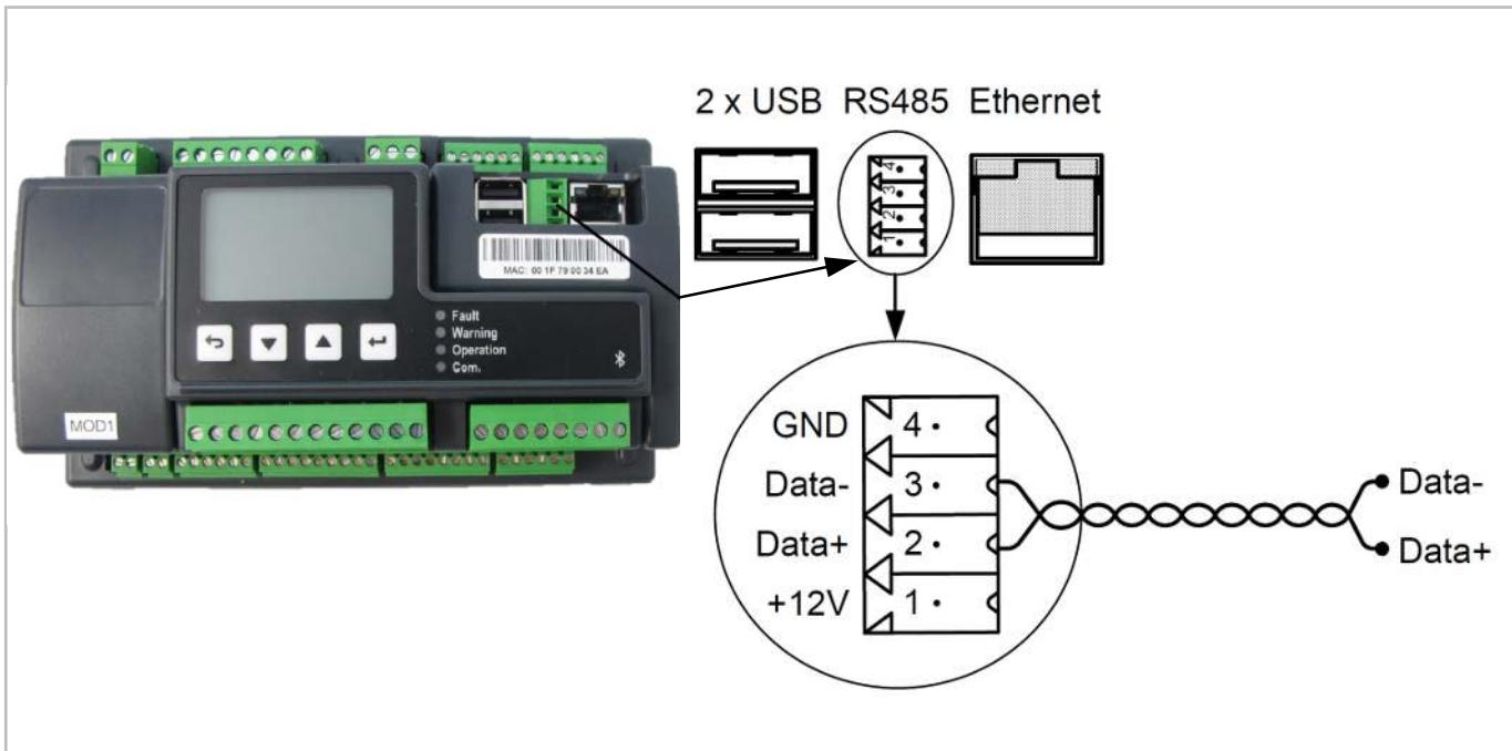
Fig. 15: Raccord Modbus sur le régulateur ECOSTAR
