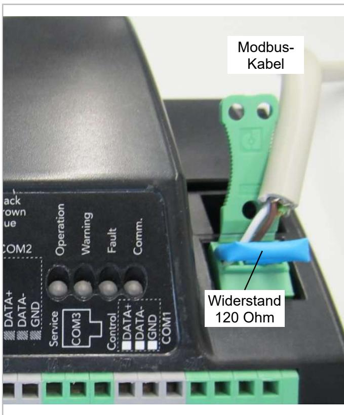
Abb. 10: Modbus-Anschluss am SE-i1
