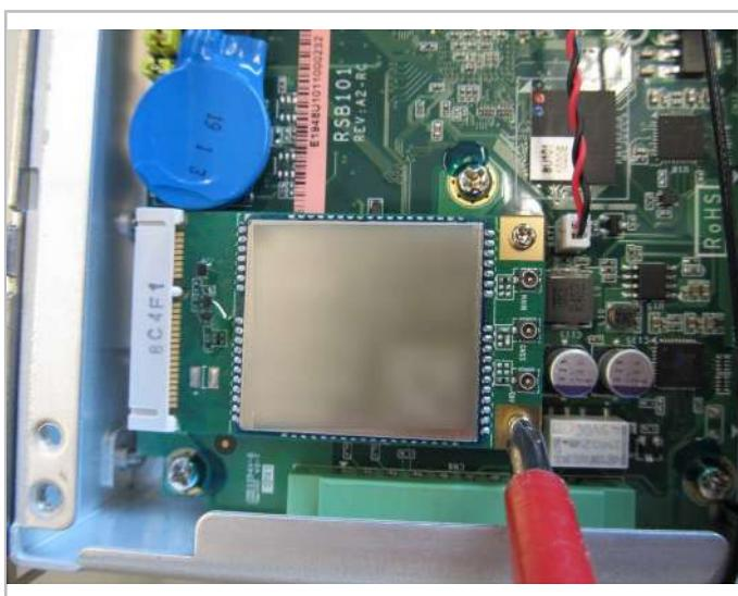
Fig. 19: Dévisser les vis sur le module GSM.
