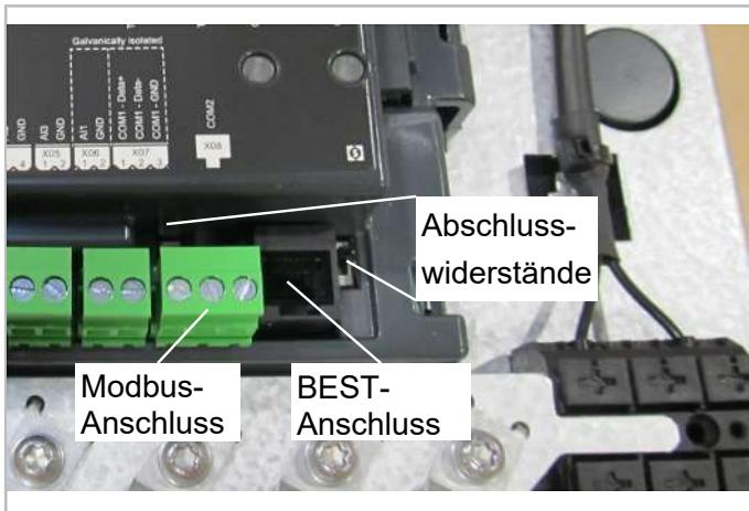
Abb. 11: Modbus-/BEST-Anschluss am CSV. Verdichter
