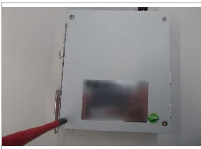
Abb. 17: Gehäuse des Netzkopplers mit einem Schraubenzieher öffnen.
