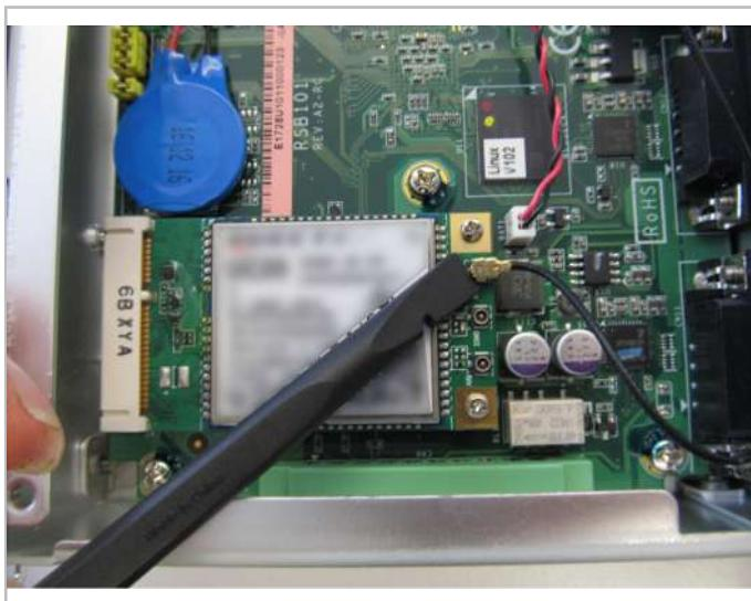
Fig. 18: Retirer le câble d'antenne du module GSM.
