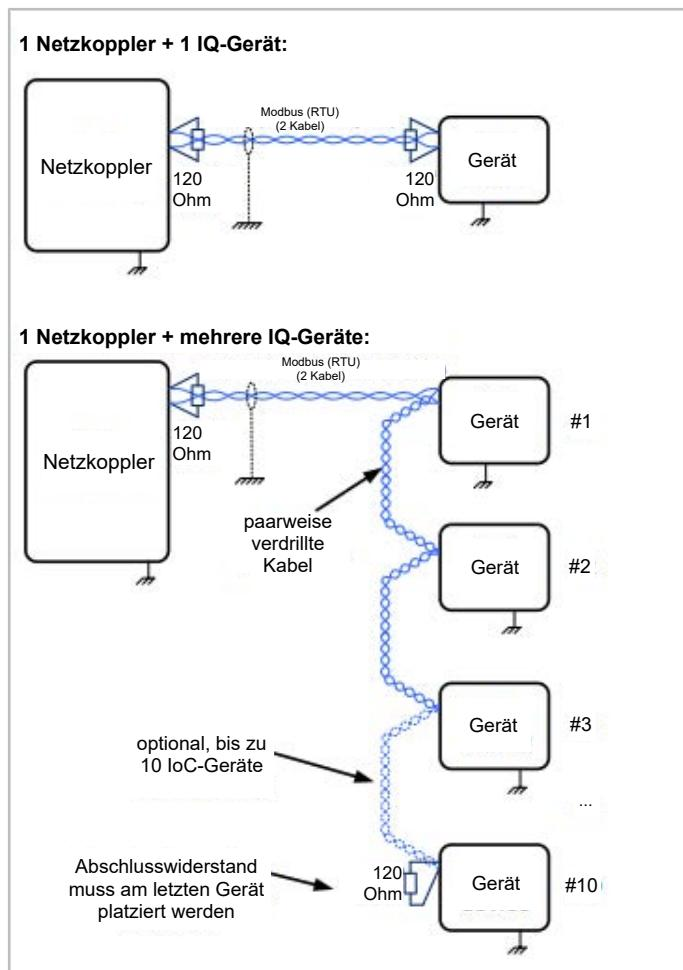
Abb. 5: Korrekte Modbus-Schaltung
