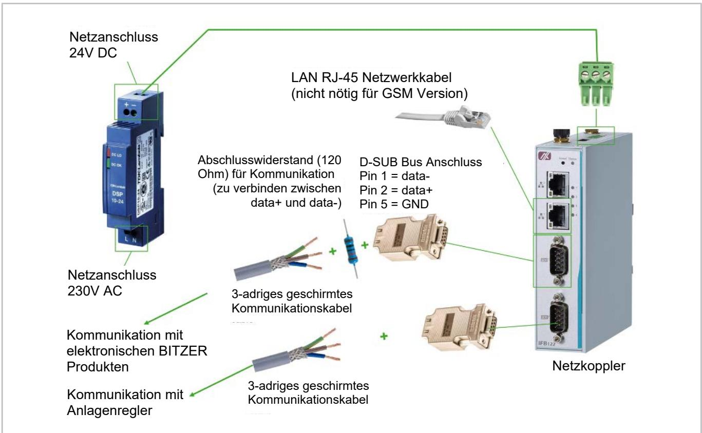
Abb. 26: Anschluss des Netzkopplers in einer Brückenkonfiguration
