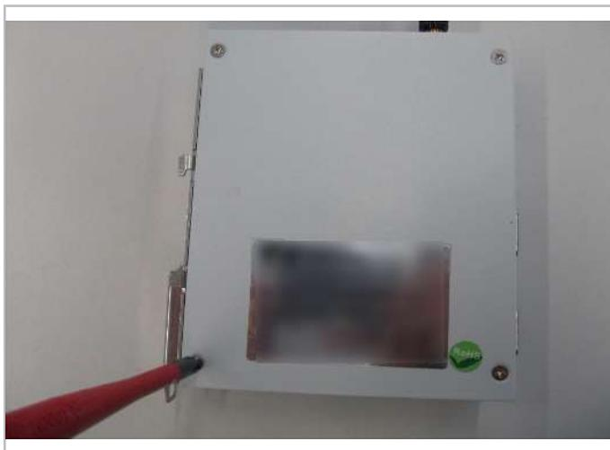
Fig. 24: Fermer le boîtier de la passerelle.
