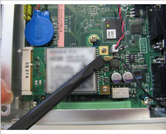
Abb. 18: Antennenkabel vom GSM-Modul entfernen.
