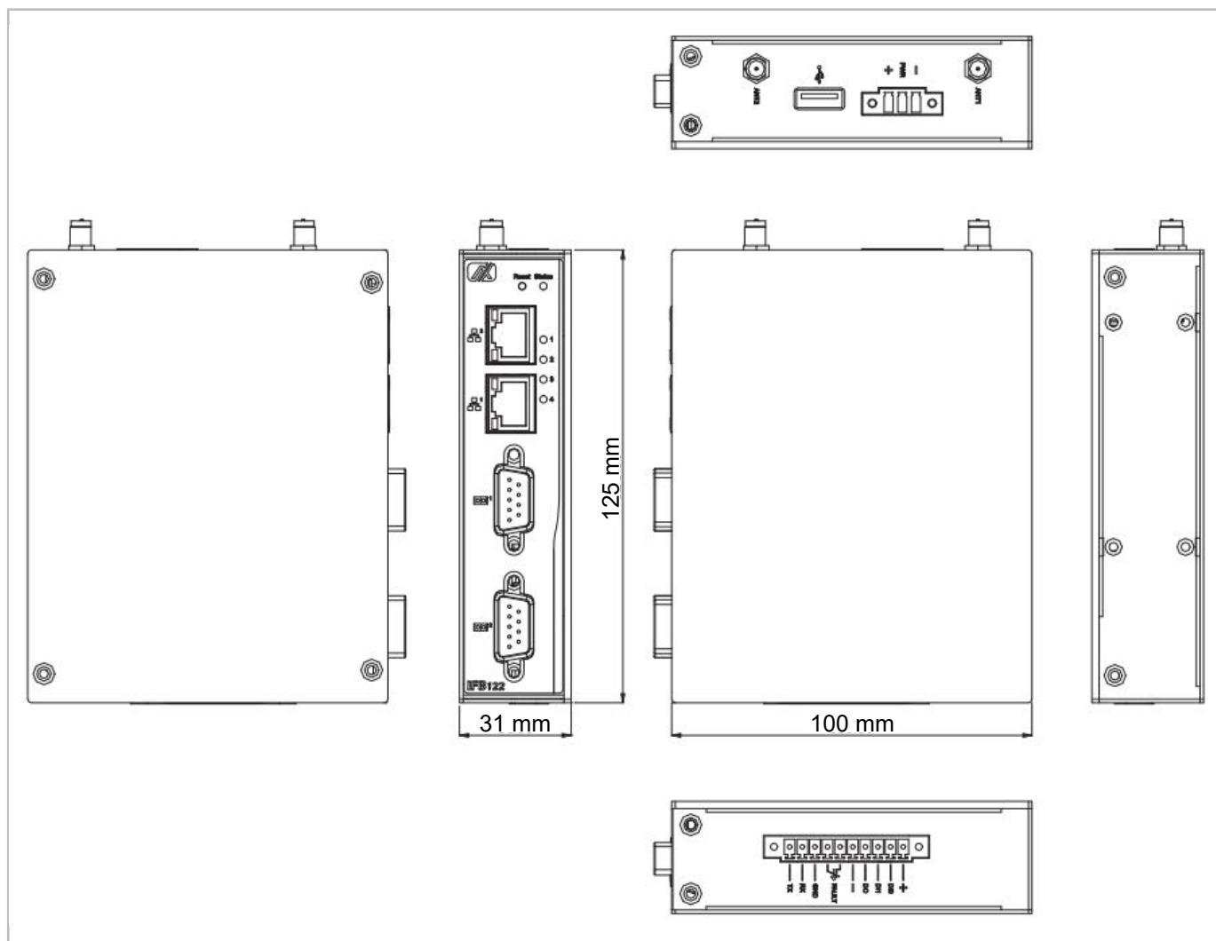
Abb. 4: Abmessungen des Netzkopplers
