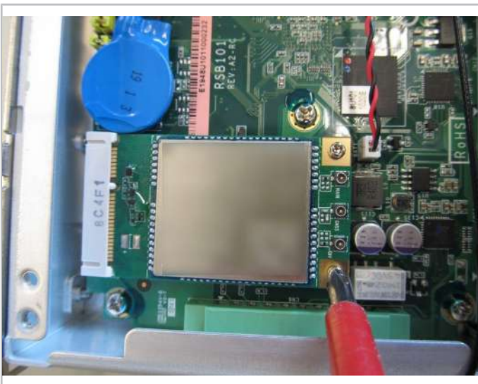
Fig. 19: Dévisser les vis sur le module GSM.
