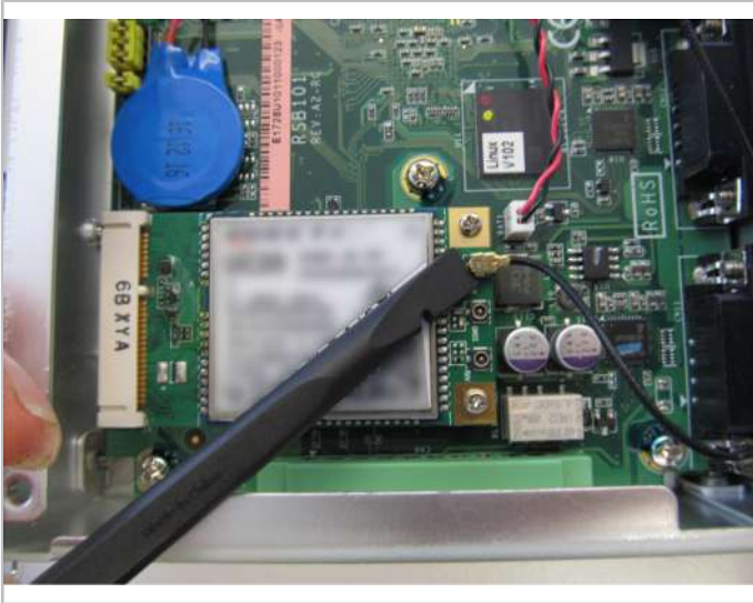
Fig. 18: Retirer le câble d'antenne du module GSM.
