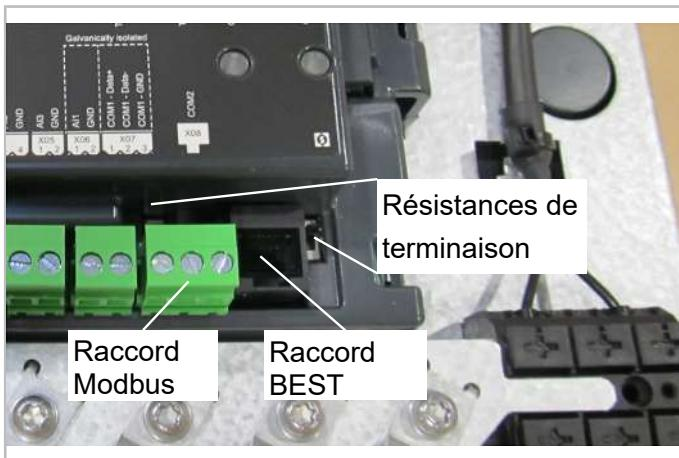
Fig. 11: Raccord Modbus/BEST sur le compresseur CSV.
