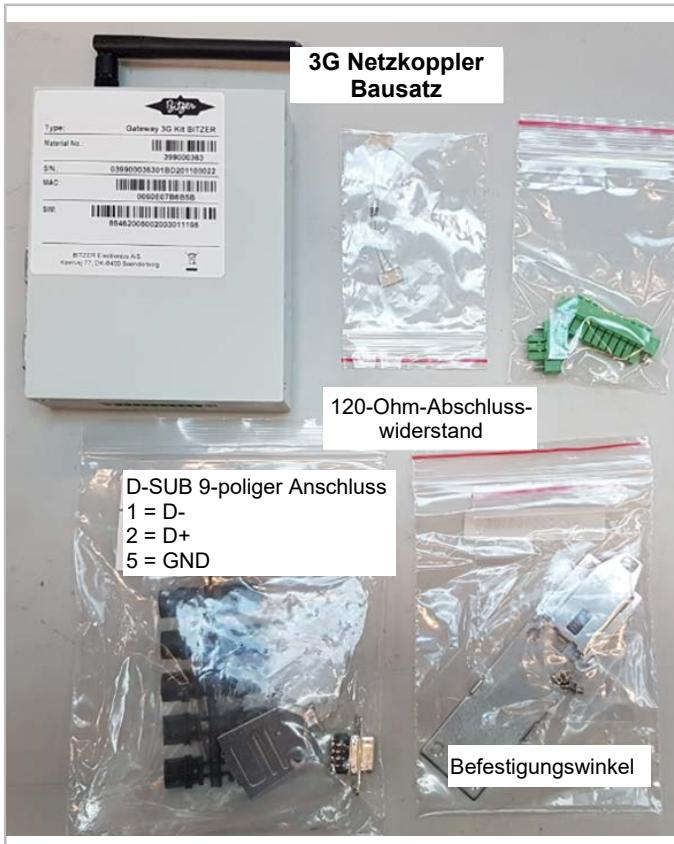
Abb. 2: Netzkoppler Bausatz (Teilenummer 347 992 01) für Montage im Schaltschrank
