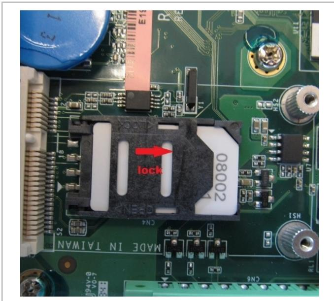
Abb. 22: SIM-Karte einstecken, Halter verriegeln.
