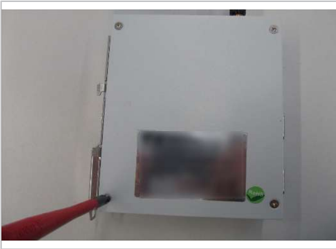
Fig. 24: Fermer le boîtier de la passerelle.
