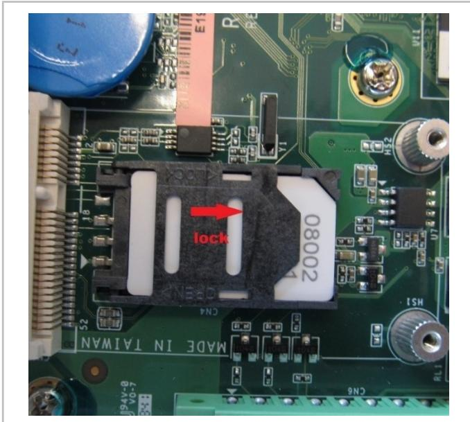
Fig. 22: Insérer la carte SIM, verrouiller le support.
