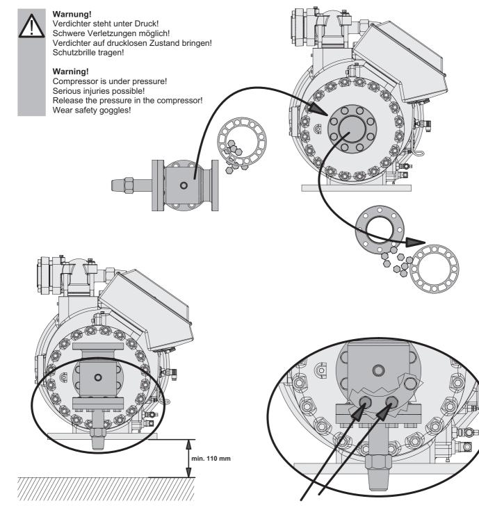
Bei Montage mit Ventilspindel nach unten: Bodenfreiheit von mindestens 110 mm vorsehen!
