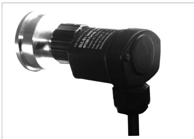
Abb. 18: Beispielfoto von Prismaeinheit auf opto-elektronischer Einheit OLC-D1
