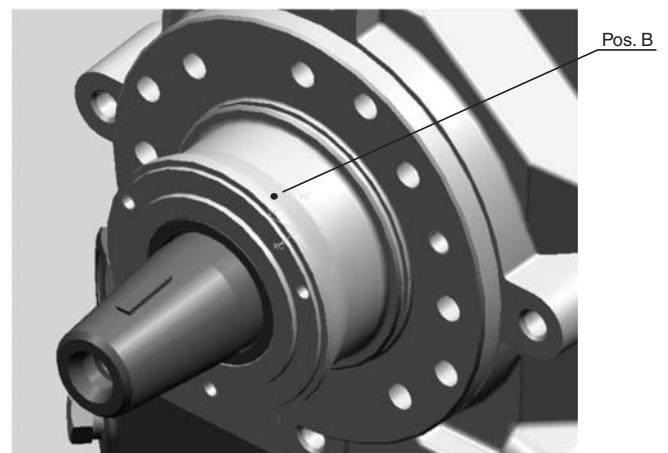
Abb. 3 Austrittsbohrung Leakageöl am Abschlussdeckel Fig. 3 Exit hole for leakage oil at the sealing cover Fig. 3 L'orifice de sortie pour l'huile de fuite dans le couvercle de fermeture
