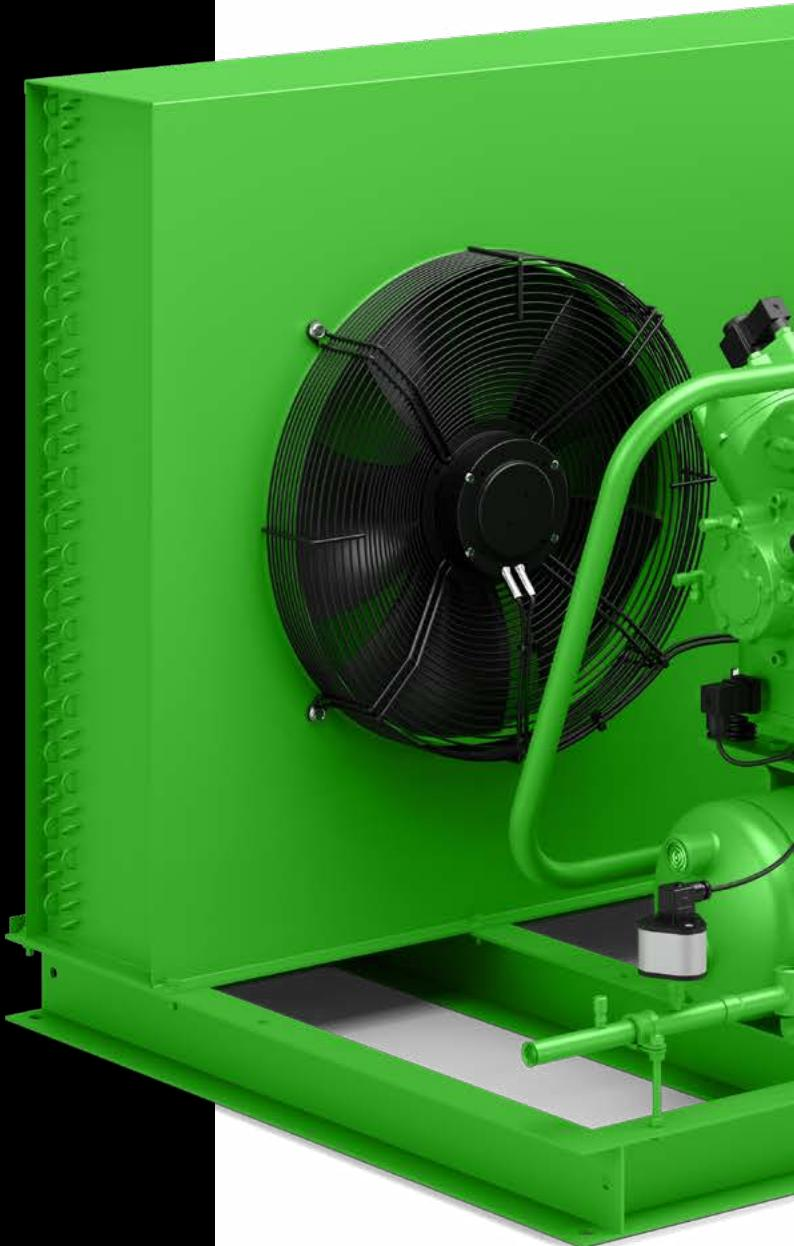
**La serie LHE ha sido aprobada para funcionamiento en diferentes aplicaciones, como entornos de BT, MT y condiciones difíciles con temperaturas ambiente muy altas. La versión básica de la unidad condensadora está equipada con un compresor de pistón ECOLINE y un recipiente BITZER, complementados a la perfección con un condensador minicanal. Se pueden diseñar soluciones flexibles con componentes adicionales de fábrica en función de los requisitos de la instalación.**
