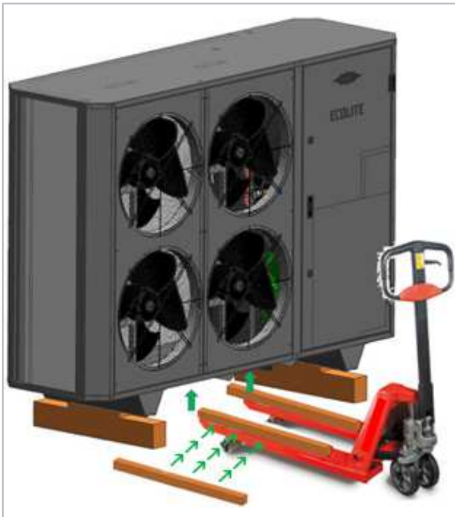
Abb. 8: Anheben mit Gabelstapler
