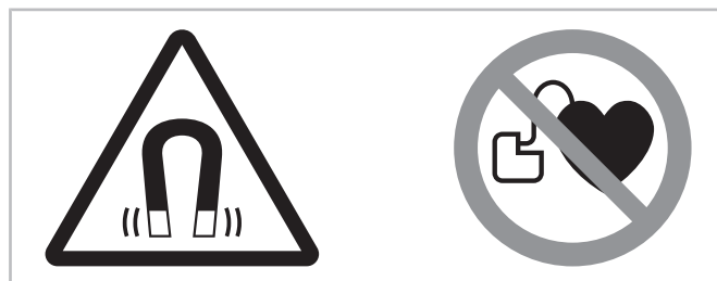
Fig. 14: Panneaux d'avertissement et d'interdiction sur un compresseur avec moteur à aimant permanent
