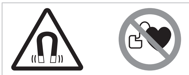
Fig. 10: Panneaux d'avertissement et d'interdiction sur un compresseur avec moteur à aimant permanent
