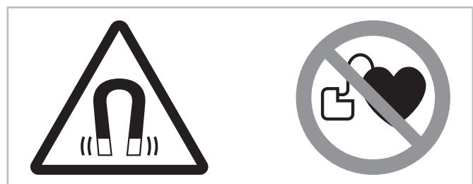
Abb. 10: Warn- und Verbotsschilder auf einem Verdichter mit Permanentmagnetmotor
