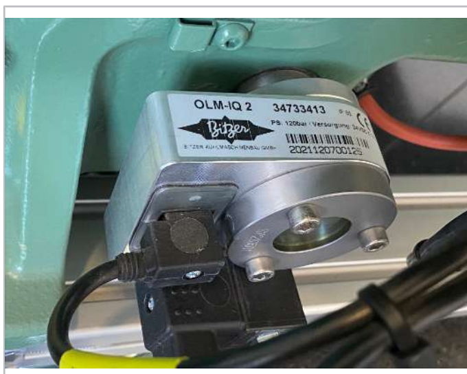
Fig. 13: Regulador del nivel de aceite OLM-IQ2 (número de la pieza 347 334 13) en el compresor (ejemplo)
