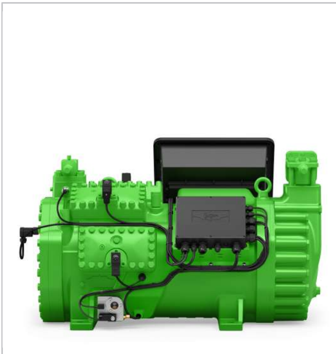
Abb. 11: Beispielhafte Ausstattung eines 8-Zylinder-Verdichters mit Verdichtermodule CM-RC-02, Druckgastemperaturfühler, Druckmessumformern, Ölheizung, Leistungsregelung CR11, Öldruckdifferenzschalter und Ölniveauregler OLM-IQ.
