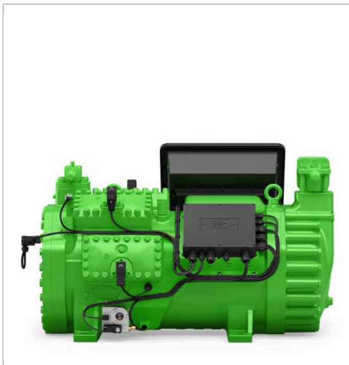
Рис. 11: Пример оснащения 8-ми цилиндрического компрессора с компрессорным модулем CM-RC-02, датчиком температуры нагнетаемого газа, датчиками давления, подогревателем масла, регулятором производительности CR11, реле давления масла и регулятором уровня масла OLM-IQ.
